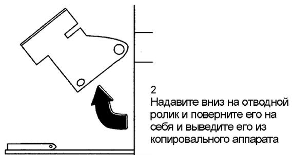
Рис. 3. Демонтаж отводного ролика.
